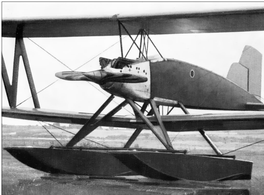
Im Jahr 1926 lief die in Travemünde gebaute „Caspar C 29“ offiziell unter der Bezeichnung Postflugzeug, tatsächlich handelte es sich aber um einen Seeaufklärer. Die Zelle war deutlich erkennbar auf Hochleistung getrimmt, sie besaß eine saubere, strömungsgünstige Linienführung und wurde von einem starken Zwölfzylinder-Motor angetrieben. Foto: ADL Arbeitsgemeinschaft Deutsche Luffahrtshistorik
